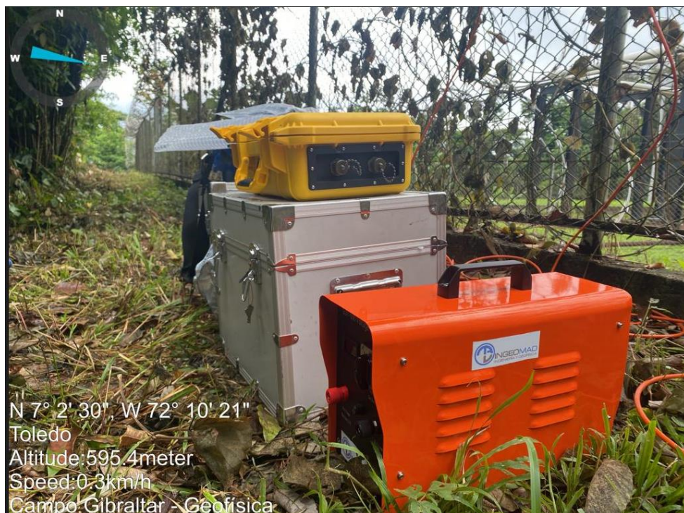
Figura 16,17. Estudios de Resistividad eléctrica _Búsqueda Tuberías EAAB
