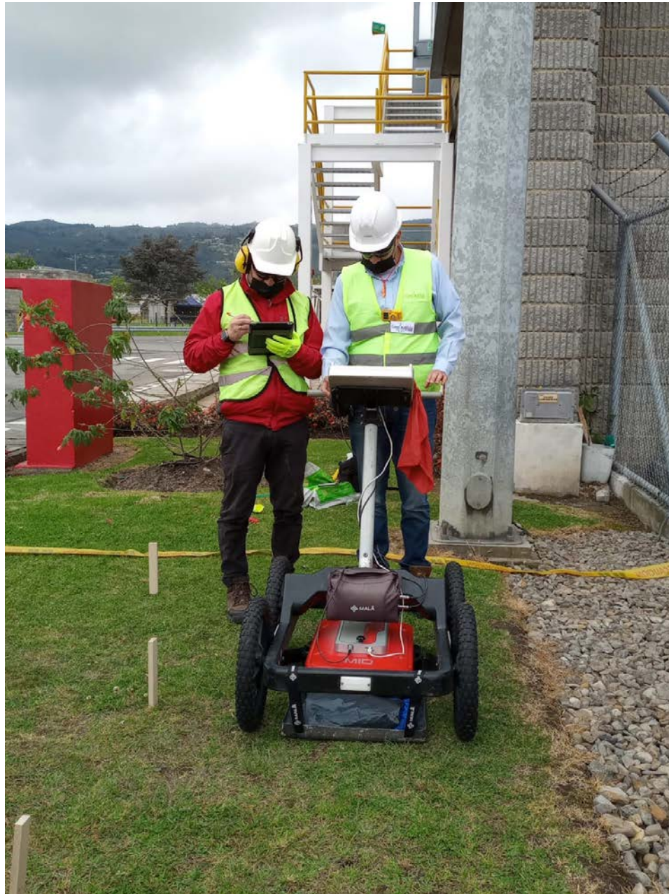
Fotografía 1. Equipo GPR MALA. Proyecto GeoAnálisis de Colombia SAS.
